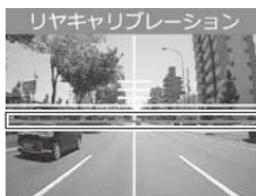
赤線が道路の水平線に合うように調整する。
