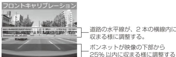
2. 本体の向きの調整（⇒ P19）および【アップ】【ダウン】スイッチを操作し、赤色の縦線が車線の中心に合うように左右方向の調整を行います。
