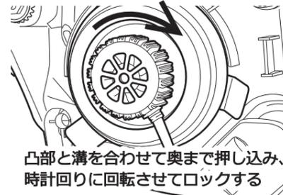
凸部と溝を合わせて奥まで押し込み、時計回りに回転させてロックする
