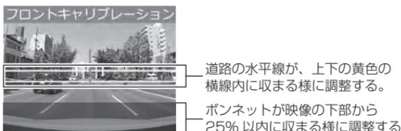
2. フロントカメラの向きの調整（⇒ P19）および【▲】【▼】スイッチを操作し、赤色の縦線が車線の中心に合うように左右方向の調整を行います。
