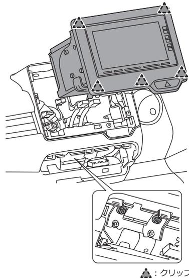
④ナビゲーション装着スペースにある、空きコネクタ（水色8ピン）と本製品のコネクタを接続します。
