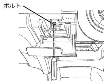
⑤グローブボックスを開け、ダンパーとピボットを切り離します。
