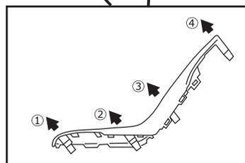
④オート A/C コントロール パネルを、クリップ6箇所、コネクタの嵌合を外して取り外します。
