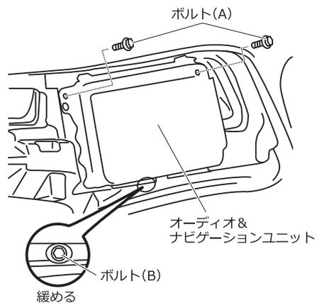
3-2.オーディオ&ナビゲーションユニットを手前に傾けてから、ボルト (B) からブラケット浮かせて、オーディオ&ナビゲーションユニットを取り外します。
