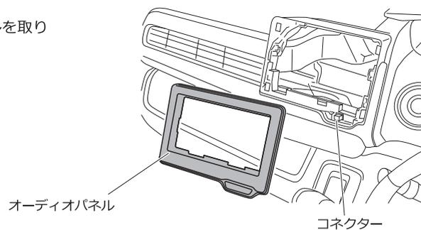
④ナビゲーション装着スペースにある、空きコネクター（水色8ピン）と本製品のコネクターを接続します。
