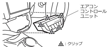
④ボルトを外したあと、クリップを浮かせてオーディオパネルを取り外します。
