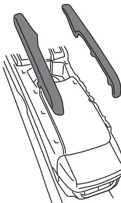
③左右のセンターコンソールサイドガーニッシュをそれぞれクリップ4箇所の嵌合を外して取り外します。クリップの嵌合は図の順番で外してください。
