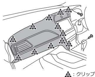
⑤クリップを外してユニットを浮かせて、コネクタを外してオートA/Cコントロールユニットを取り外します。
