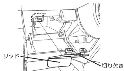
④ロアガーニッシュを外した部分からドライバーを入れ、モニターを止めているボルトを取り外します。※ボルトは「②」のリッド部分から確認できます。
