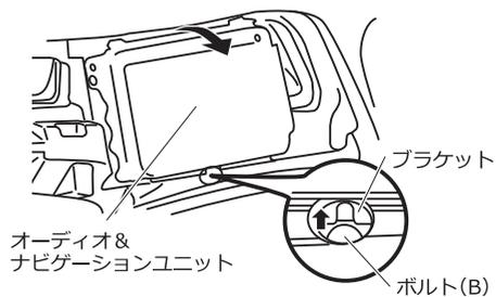
④ナビゲーション装着スペースにある、空きコネクター (水色8ピン) と本製品のコネクターを接続します。
