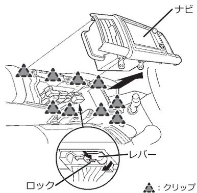
③ナビゲーション装着スペースにある、空きコネクター（水色8ピン）と本製品のコネクターを接続します。
