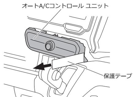
②裏面のコネクターを外してオートA/Cコントロールユニットを取り外します。開口部を覗くと、デッキ固定スクリューが2本ありますので、それを外してください。
