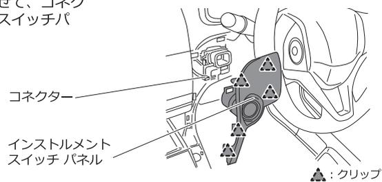
④必ずスクリー2本を取り外してから、クリップを外してパネルを浮かせてください。コネクタを外してインストルメントアシスタコネクタを外してインストルメントアシスタントパネルを取り外します。
