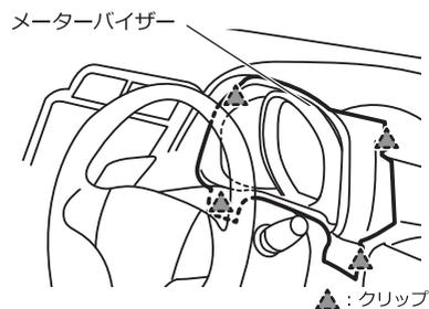
④クリップを浮かせ、エアコン吹出し口を取り外します。
