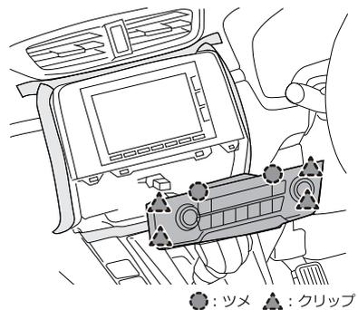
④コネクタおよびスクリューを外してセンターパネルを取り外します。
