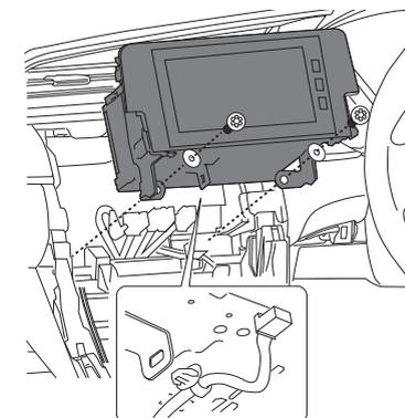
⑥ナビゲーション装着スペースにある、空きコネクタ（水色8ピン）と本製品のコネクタを接続します。
