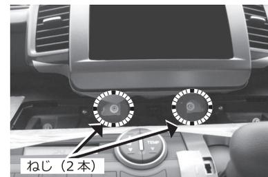
画面下の切り込み部にリムーバーを差し込んで後方へ引き、別のリムーバーを隙間に差し込んで周囲を浮かせます。
