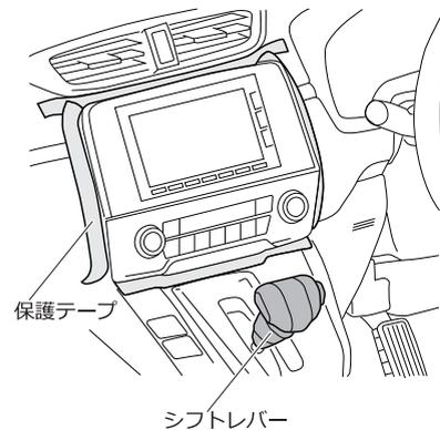
③コネクタを外してA/Cコントロールユニットを取り外します。
