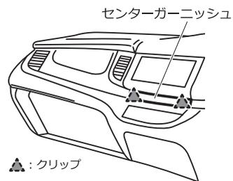
③クリップを浮かせ、エアコンコントロールユニットを取り外します。
