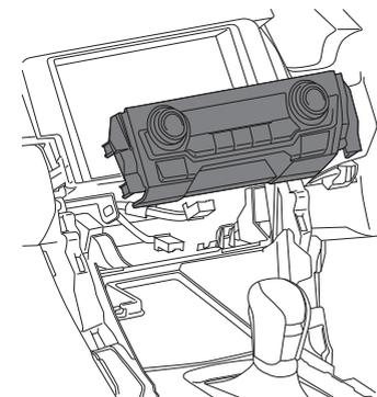
⑤センターパネルを、ボルト2本、クリップ4箇所、コネクタの嵌合を外して取り外します。
