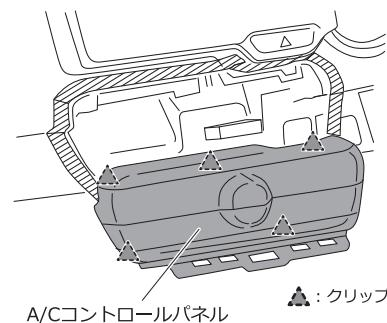
④センターパネルおよびナビデッキ引き出し、クリップのかん合をとボルト2本を外し、センターパネルおよびナビデッキを手前に引き出します。
