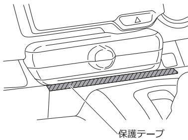
②シフトパネル取り外し、クリップとツメのかん合を外し、シフトパネルを取り外します。
