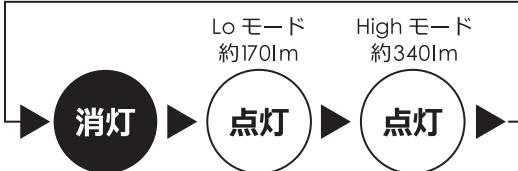
※Loモードで約5秒以上点灯した後に、電源スイッチを押すと消灯します。
